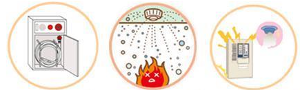
①屋内消火栓設備 ②スプリンクラー設備 ③自動火災報知設備
